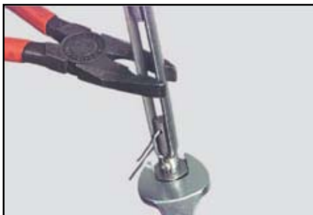
21. Kontramutter på strekkfisker trekkes til.
